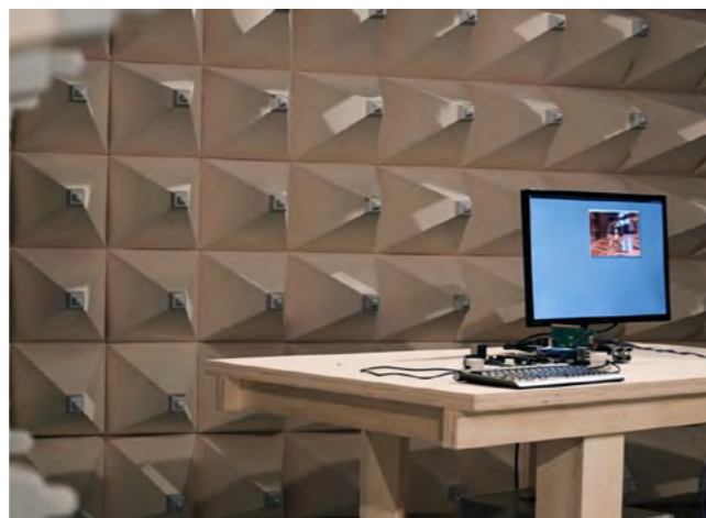
Figura 38: Stabilimento di Arezzo, camera anecoica
